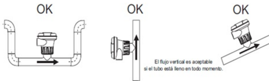
Figura 5.13: Colocación del sensor de flujo en un interceptor o en un sitio de flujo ascendente
