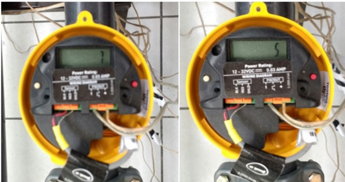
Figura 5.16: Configuración de nuestros sensores 2537 Paddlewheel Flow Sensor con una Sensitivity (sensibilidad) de 7 y un Average (promediado) de 05 segundos, para la obtención de datos estables
