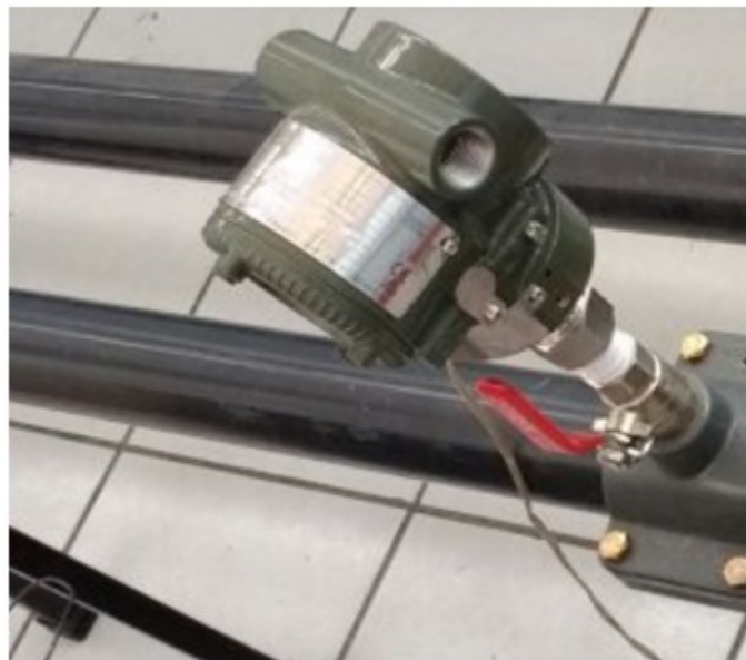
Cuadro 5.5: Válvula manual para activar o desactivar la lectura del sensor
