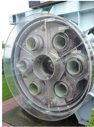
Figura 2.4: Conductos de salida de MHD del Yamato I
