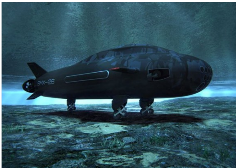
Figura 2.5: SMX 26, un submarino capaz de «aterrizar» en el fondo del mar
