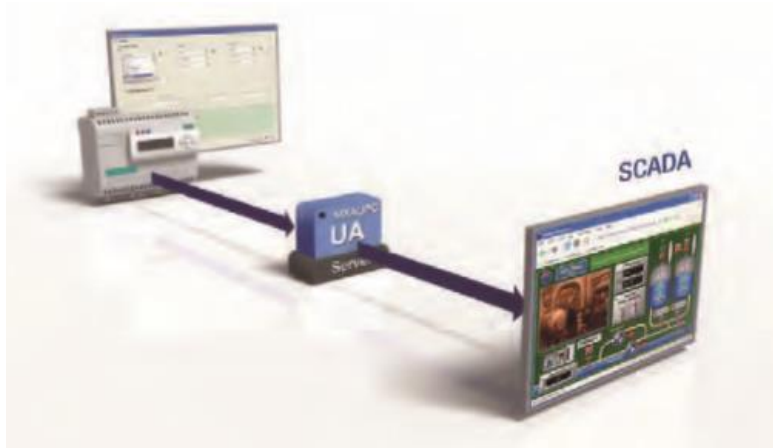
Figura 2.4 Representación de la comunicación entre el Iologik/MOXa E2210, el servidor SCADA.
