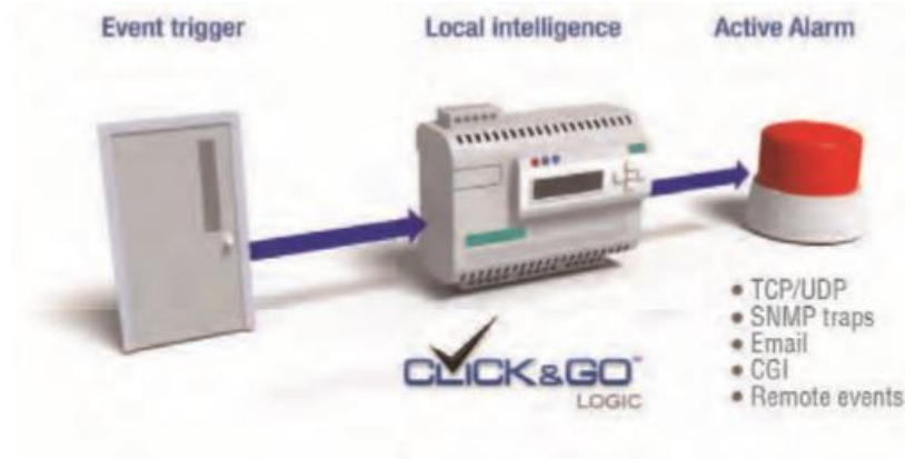
Figura 2.2 Representación del enlace entre ioLogik/MOXA E2210, alarmas y variables a través de los diferentes protocolos de comunicación.
