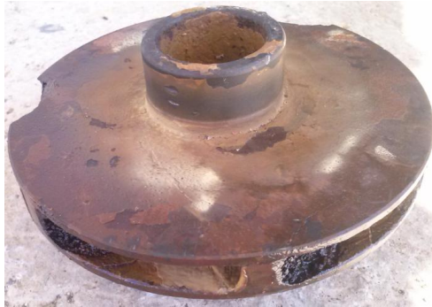
Fig. No 17.- Rodete dañado debido a la cavitación
