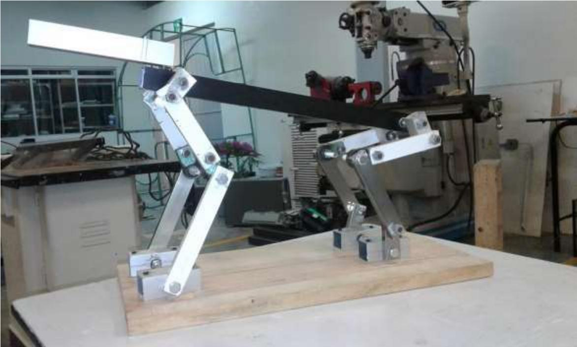
**Figura 4.7.** Exoesqueleto completamente terminado, anclado a suelo y con todas sus articulaciones funcionales.
