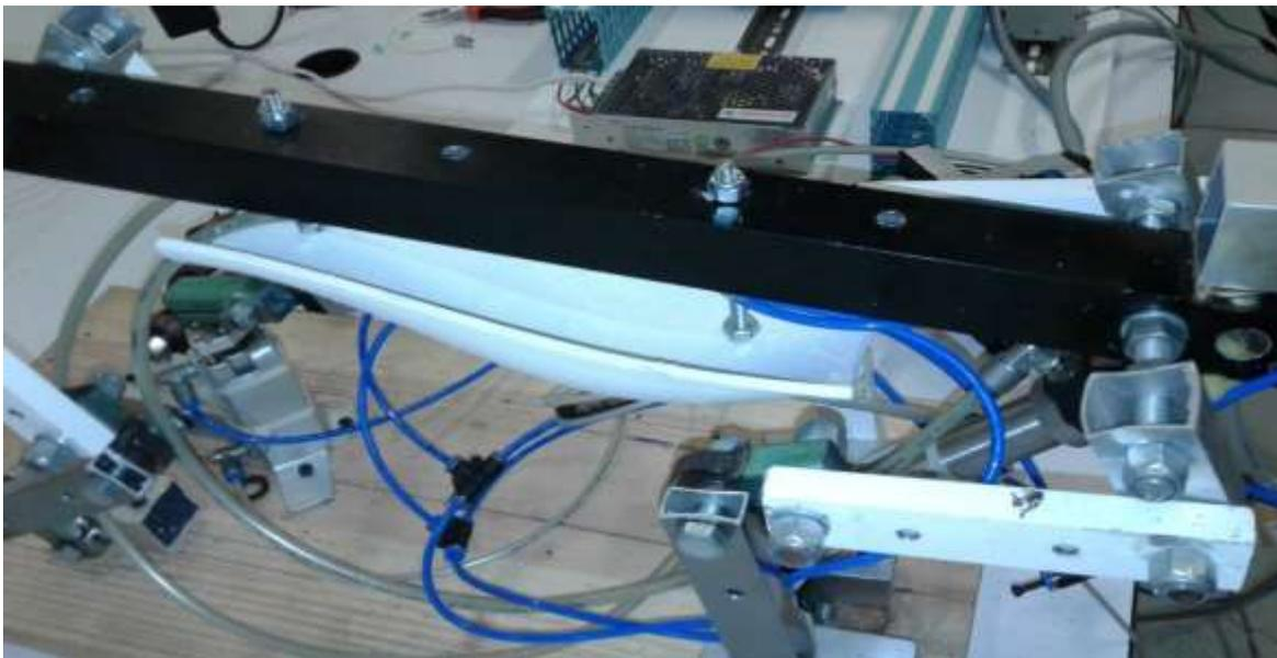
**Figura 4.41.** Un ejemplo del ensamblaje de las piezas impresas, en este caso el abdomen.
