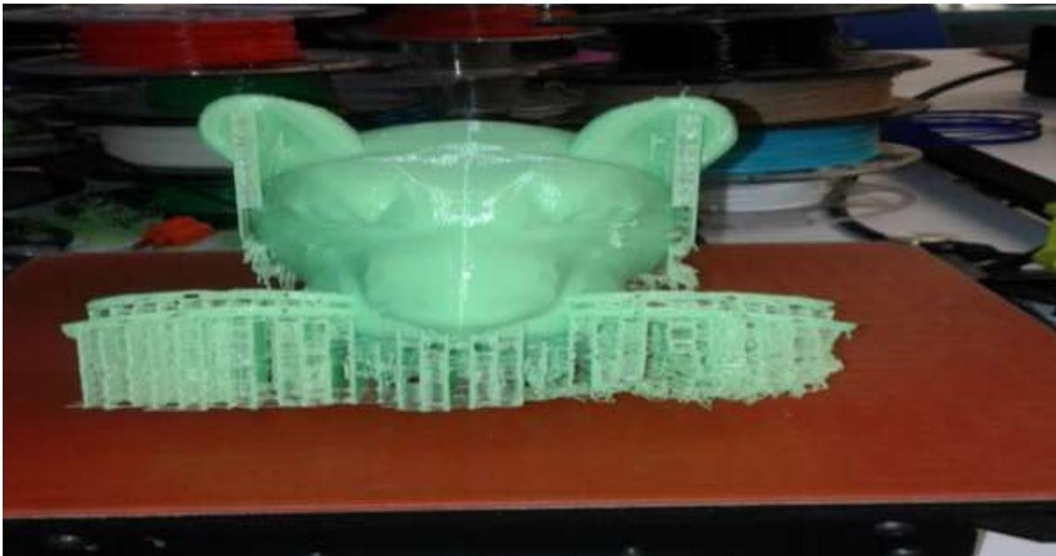
**Figura 4.34.** Impresión de la cabeza terminada
