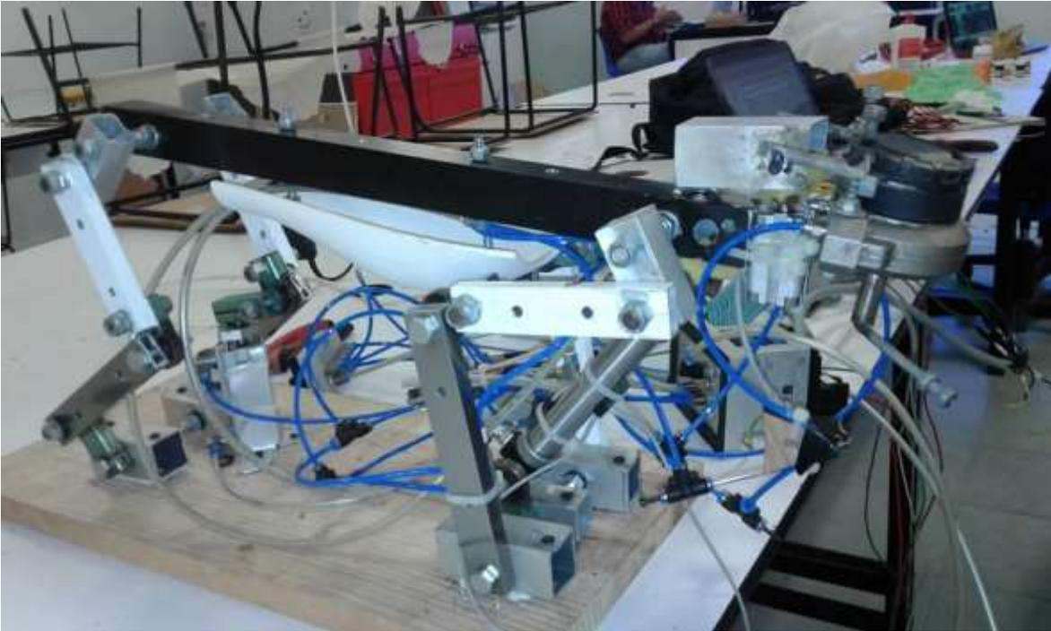
**Figura 4.11.** Vista del exoesqueleto con todo el sistema neumático
