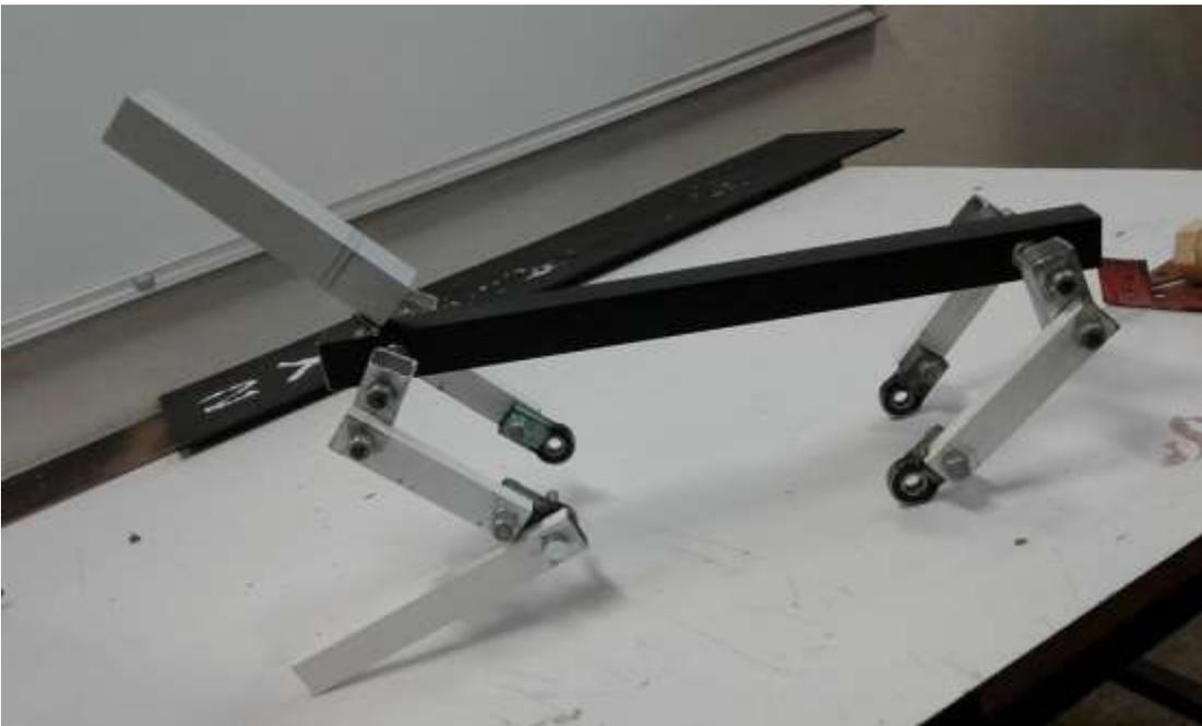
**Figura 4.4.** Exoesqueleto al que se le ha añadido el cuello, adherido a la columna mediante una bisagra
