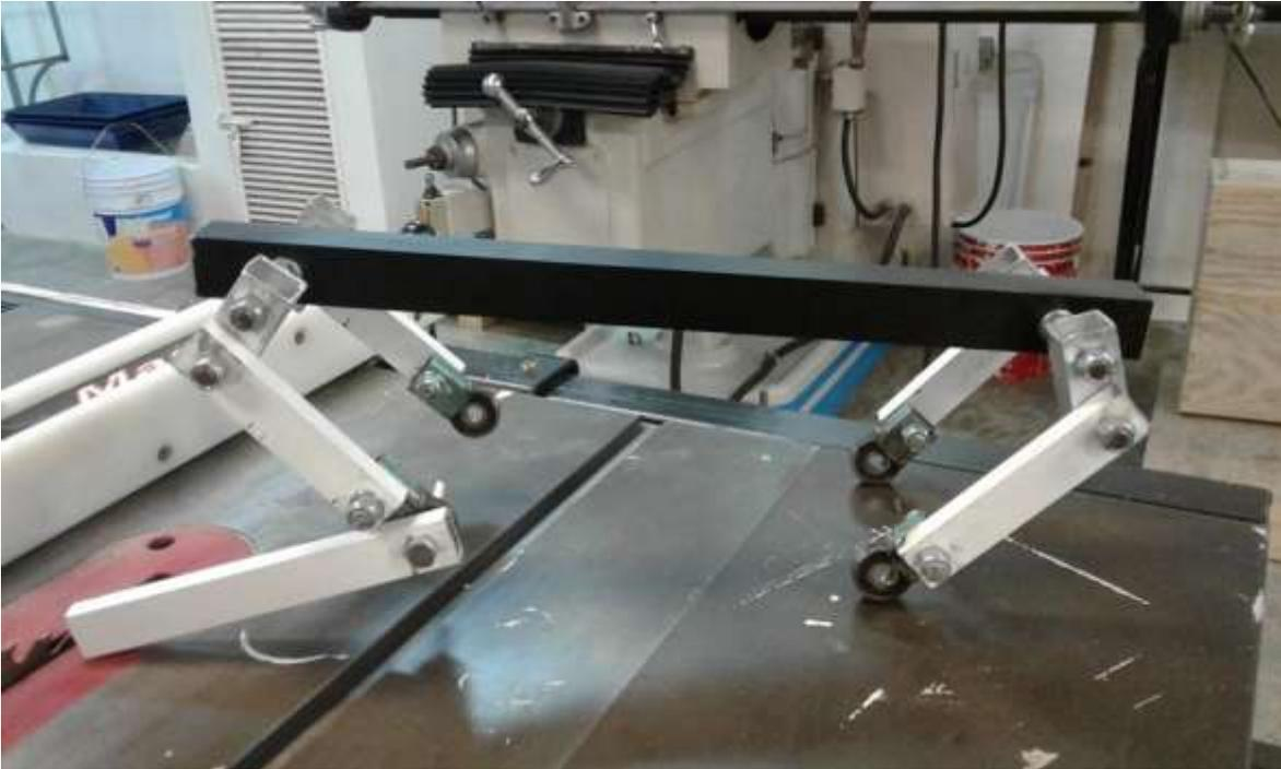
**Figura 4.3.** Exoesqueleto con 4 baleros soldados, los cuales fungen como codos y rodillas.
