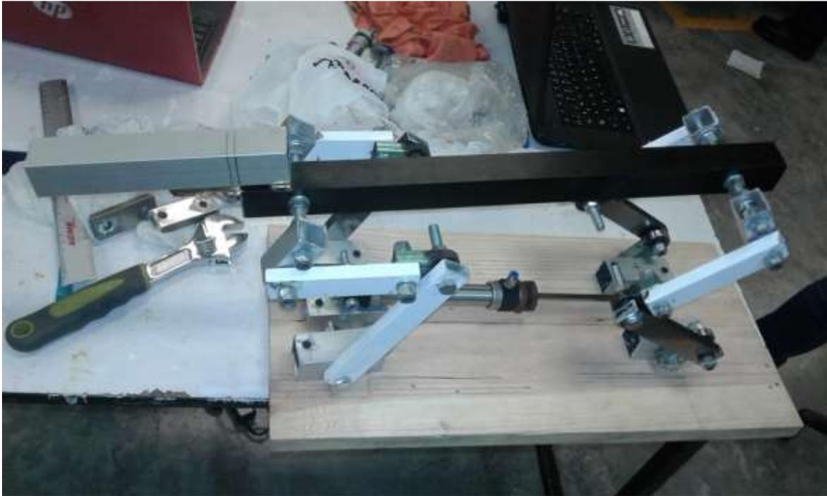
**Figura 4.8.** Vista superior del exoesqueleto con los pistones integrados.
