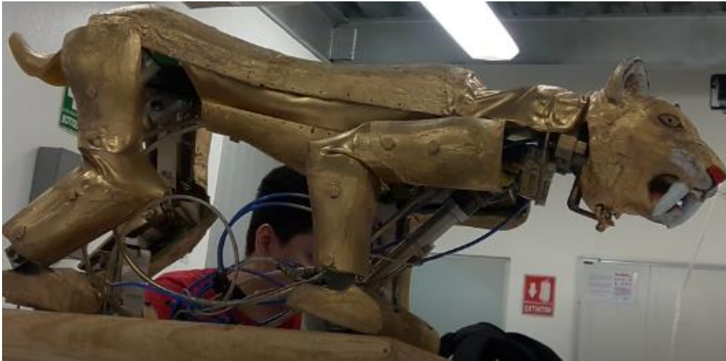
Figura 5.21 Animatronic en posición de acostado con la cabeza hacia la derecha y el cuello levantado
