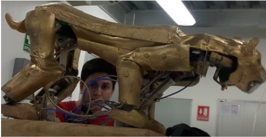
Figura 5.19 Animatronic en posición de agazapado (se puede observar el pistón trasero levemente alzado)
