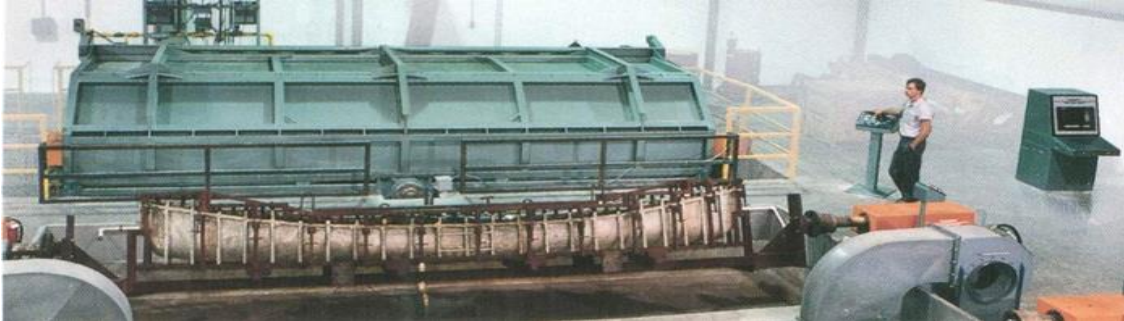
Figura 3.3 Máquina de rotomoldeo tipo Rock and Roll
