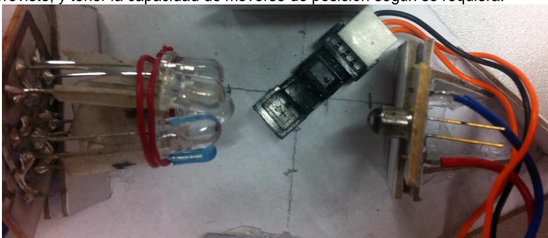
Figura 13. Posición de la fuente de luz y el fotodiodo.
