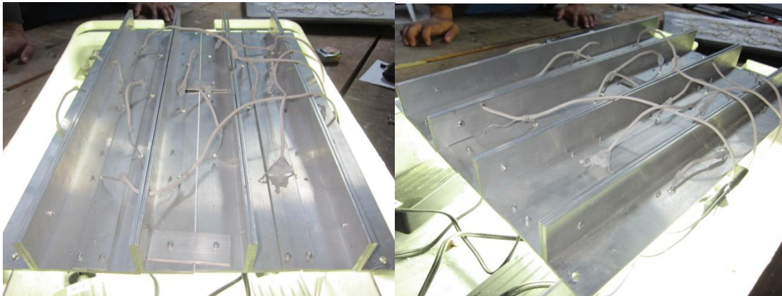
Figura (8-3): Fotografías del disipador montado actualmente en las lámparas LED (se puede apreciar que disponen de cuatro aletas)
