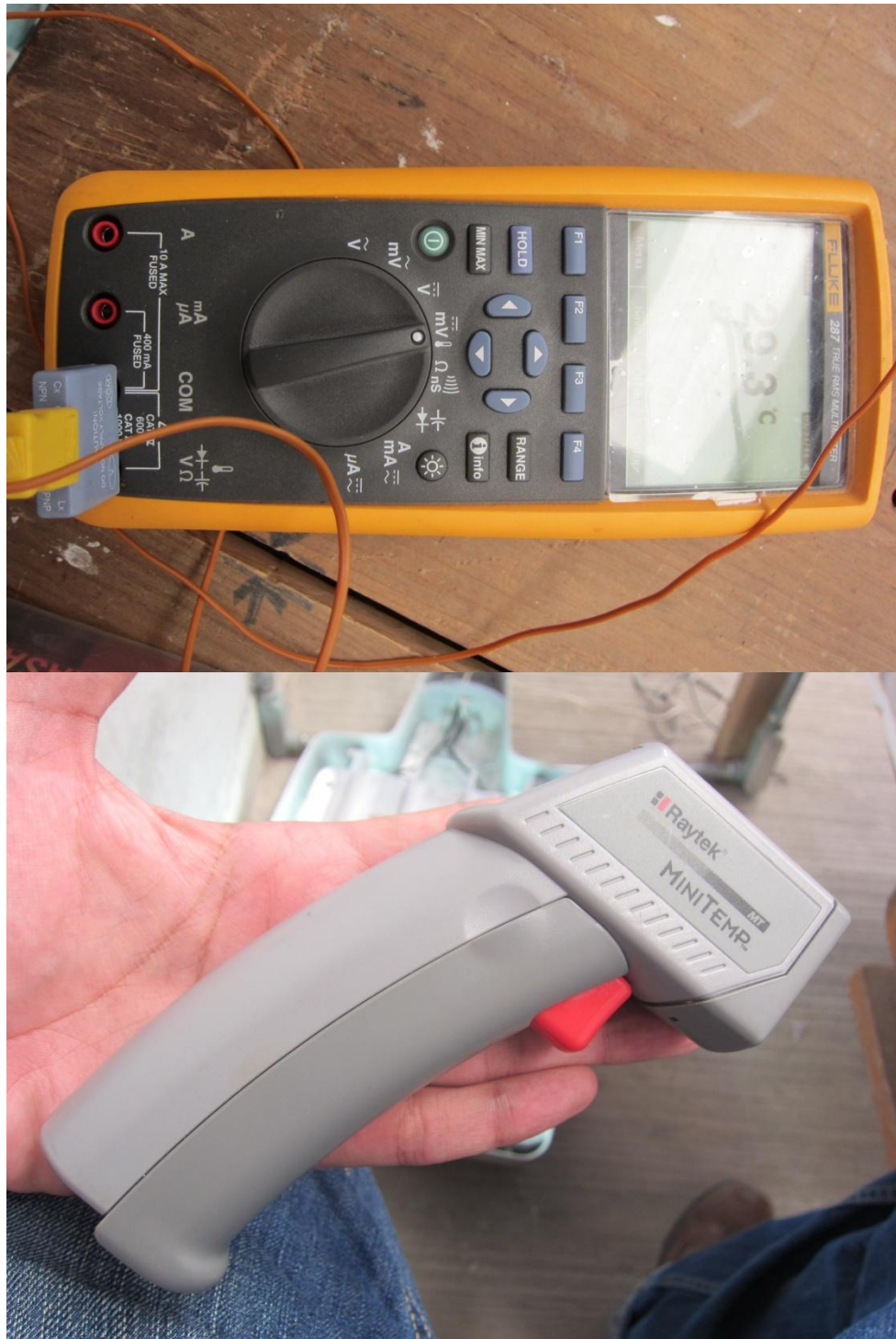
Figura (B-5): Instrumentos de medición utilizados para la toma de lecturas de la temperatura en el disipador: arriba un termómetro termopar, abajo un termómetro tipo láser
