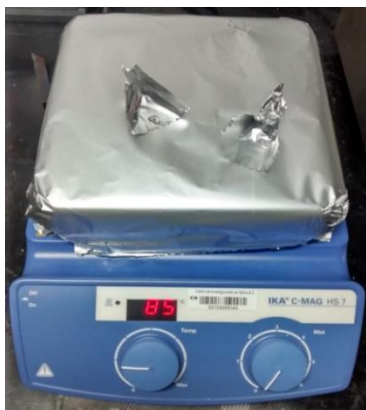
Fig. 3.15 Parrilla eléctrica del laboratorio del GPOM-CIO
