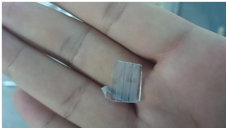
Figura 20. Una primera capa de Magic Tape para plasmar los rectángulos horizontales correspondientes a los electrodos.
