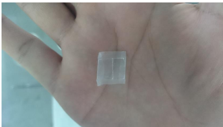
Figura 21. Un segundo trazo, para plasmar el canal conductivo o separación entre electrodos.
