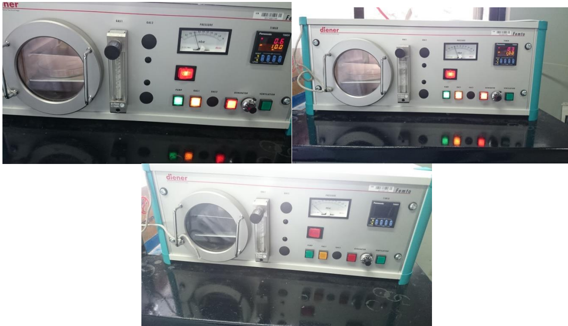
Figura 15. Equipo utilizado en el laboratorio de materiales, para llevar a cabo el tratamiento de plasma a sustratos o muestras que lo requieran.
