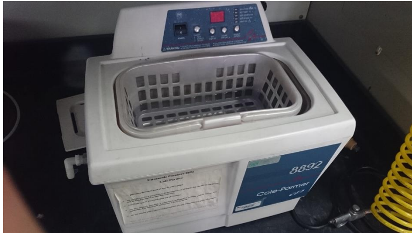
Figura 12. Equipo para realizar baño sónico utilizado en el laboratorio de materiales del GPOM, para sonicar soluciones y compuestos.
