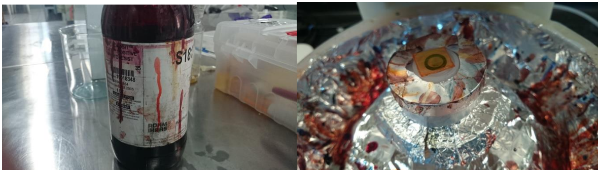
Figura 18. Fotoresist empleado para hacer el diseño de las máscaras por fotolitografía, y modo en el que se llevó a cabo el proceso de depósito con spin-coating.
