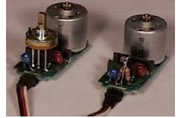
Fig. 2.3 Componentes internos de un servomotor.
