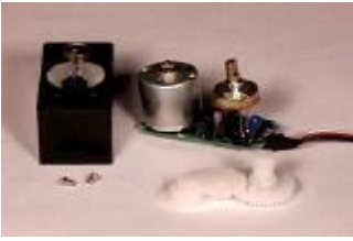
Fig. 2.2 Diseño físico del servo.
