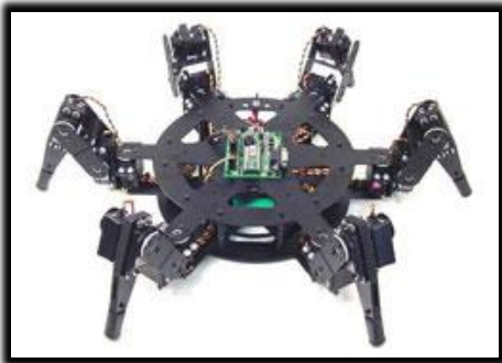
Fig. 2.12 Prototipo electromecánico de un robot hexápodo.
