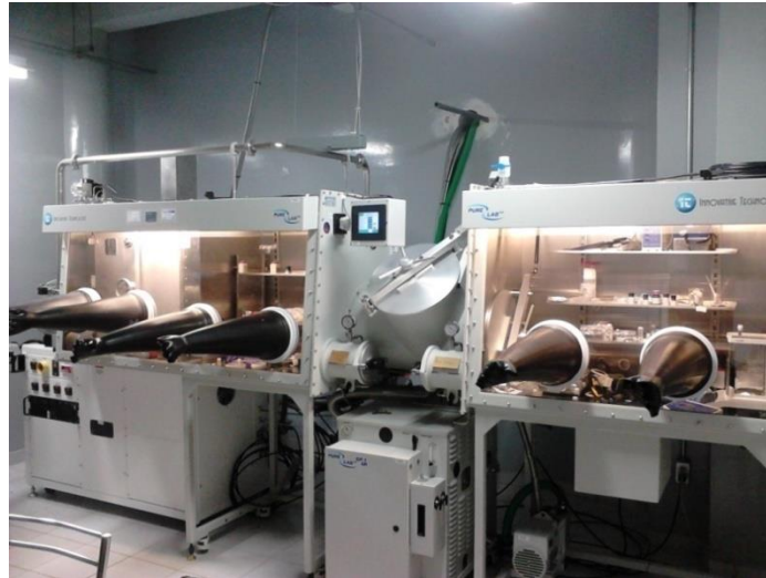
Fig. 2.13 Cajas de guantes utilizadas en el laboratorio de materiales del GPOM.
