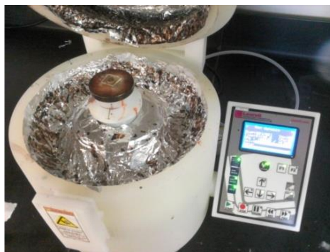
Fig. 3.9 Spinner utilizado para el depósito de disoluciones.
