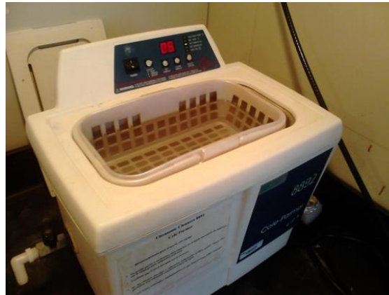
Fig. 2.14 Cuba de ultrasonido marca Cole-Parmer 8892 utilizada en el laboratorio de materiales.
