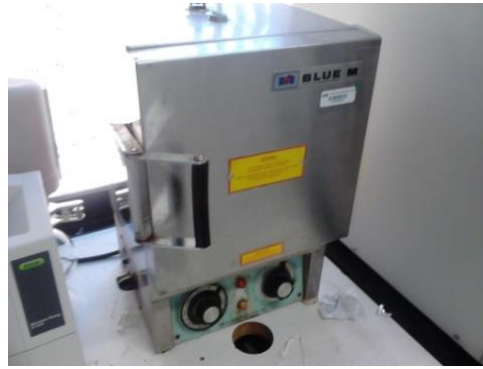
Fig. 3.10 Mufla utilizada para el secado de las películas depositadas.
