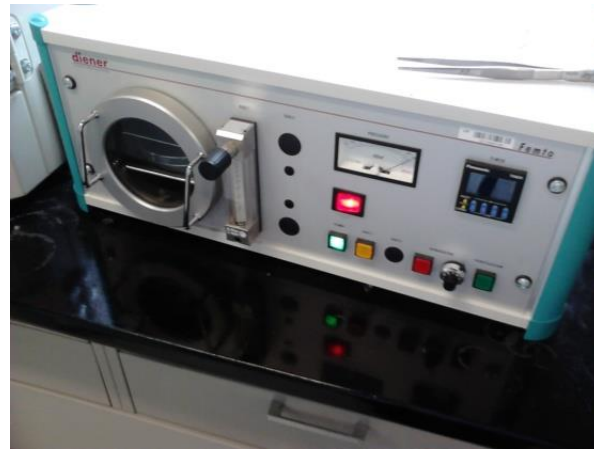
Fig. 2.16 Aparato de tratamiento de plasma marca Diener utilizado en el laboratorio de materiales del GPOM.
