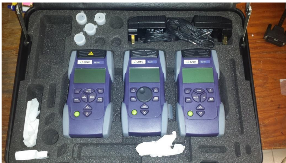
ILUSTRACIÓN 61- KIT MEDIDOR DE POTENCIA ÓPTICA.
