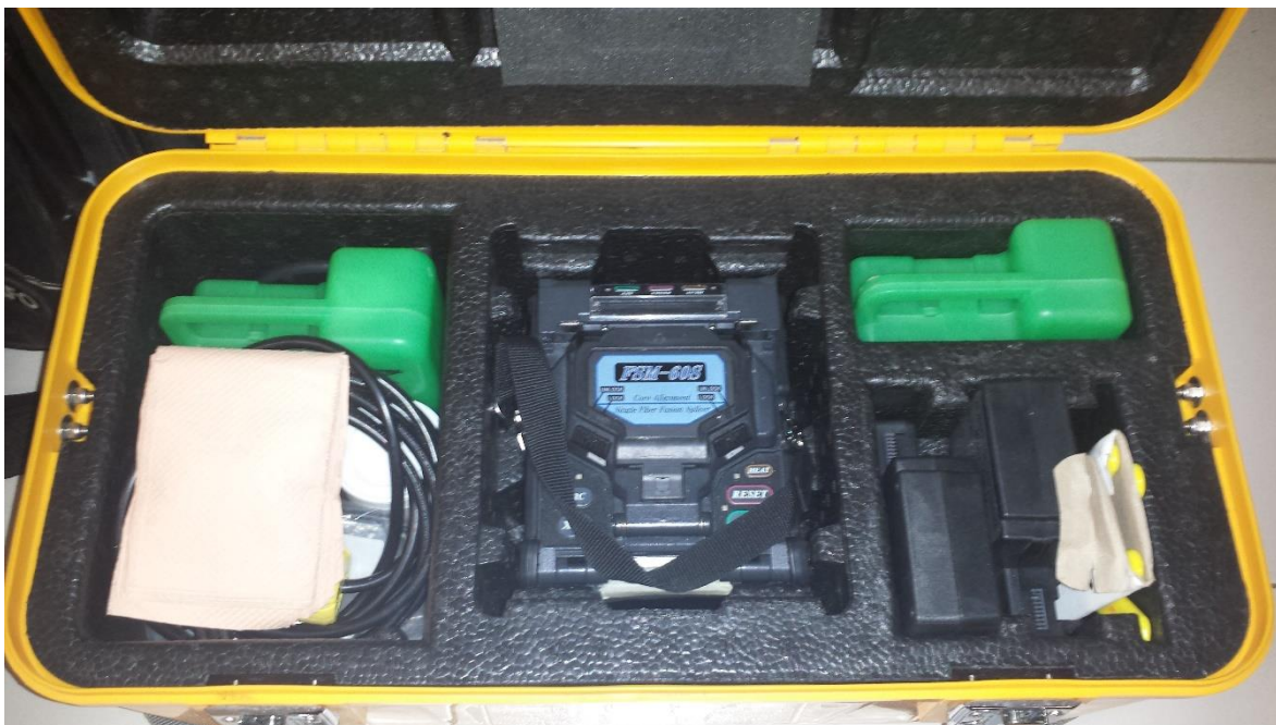
ILUSTRACIÓN 62- KIT DE EMPALMADORA FUJIKURA
