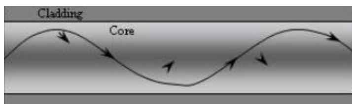
ILUSTRACIÓN 16- PERFIL DE LA FIBRA DE ÍNDICE GRADUAL.
