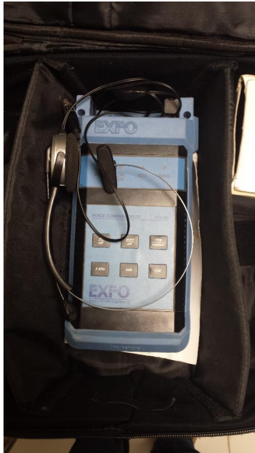
ILUSTRACIÓN 63- COMUNICADOR ÓPTICO EXFO VCS-20A
