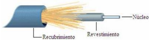
ILUSTRACIÓN 11- PARTES COMPONENTES DE LA FIBRA ÓPTICA
