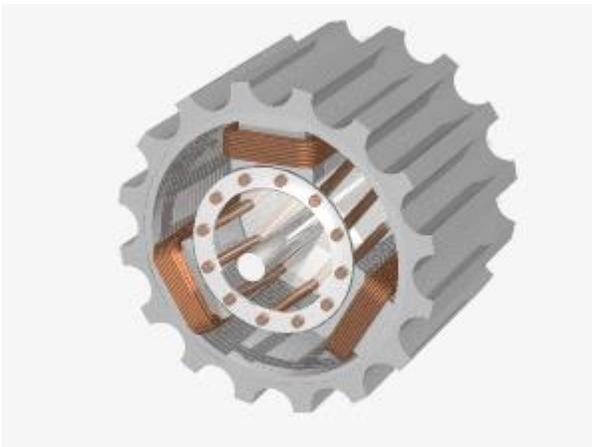
Motor asíncrono con rotor en forma de jaula de ardilla.
