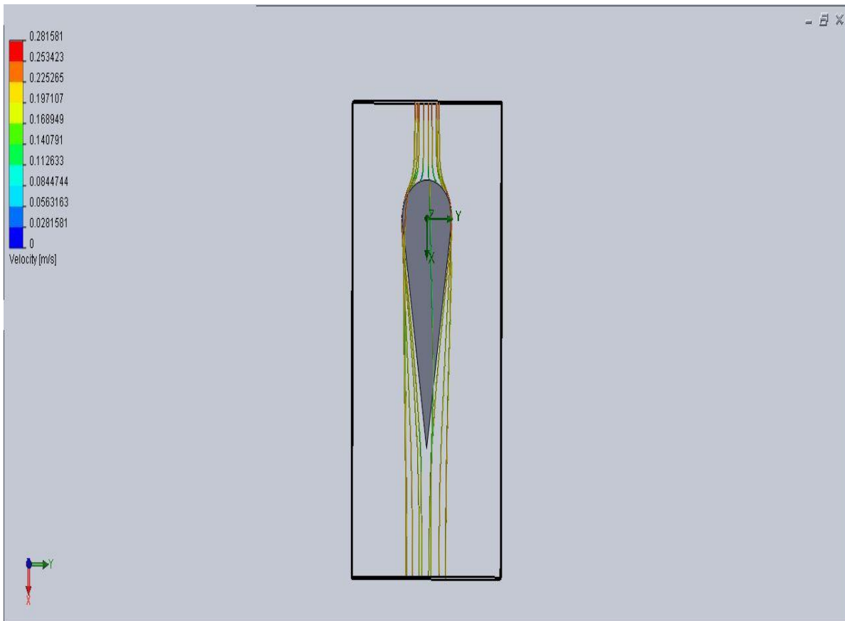
Fig. 3.34 Simulación de las diferentes velocidades que sufre el flujo
