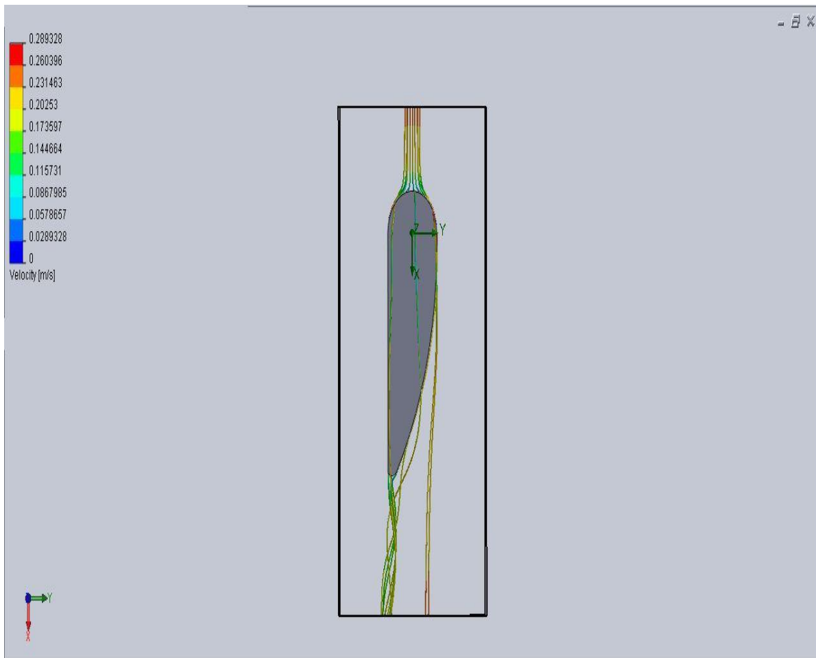
Fig. 3.30 Simulación de las diferentes velocidades que sufre el flujo
