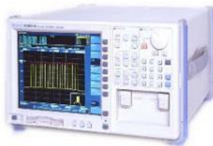
Figura.4.2. Analizador de espectro óptico modelo AQ6319
