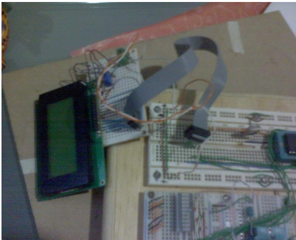
Figura 7.15.- conexión PIC-LCD a 4 bits.
