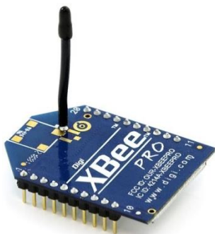
Figura 3.12: Modulo Xbee con antena incluida
