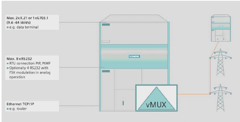
*Figura 3.35 transmisión de datos del equipo Powerlink*
