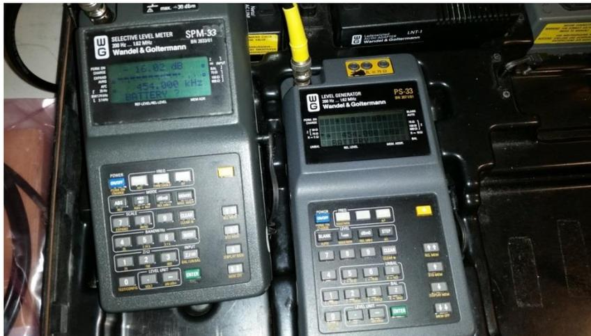
**Figura 4.15** equipo generador de nivel y medidor selectivo de nivel
