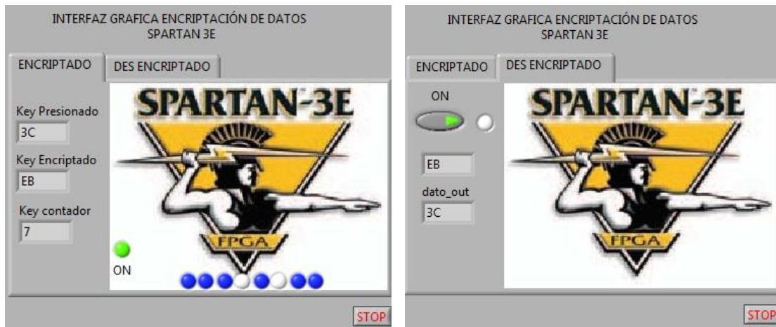
Figura No. 24: Interfaz Grafica en Labview, muestra el resultado de la encriptación y des encriptación
