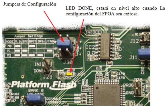
Figura No. 4: Ubicación de jumpers de configuración y led done
