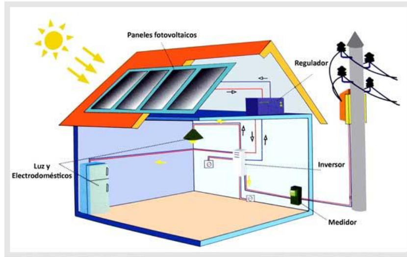
Figura 10. Sistema fotovoltaico conectado a red.
