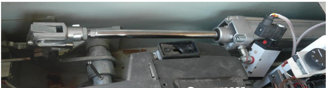
Figura 3.3.1.i Pistón cambiando de posición
