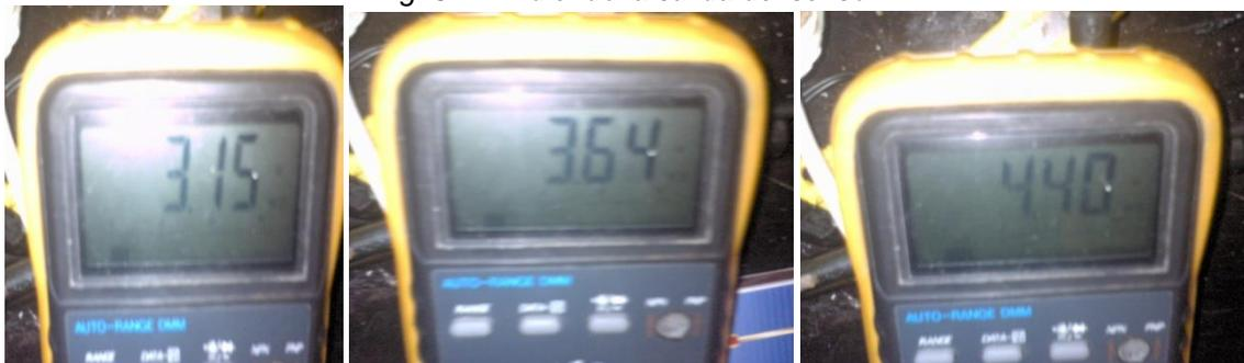
Fig. 3.25 Valores del sensor, abajo del límite inferior, en medio y arriba del límite superior de temperatura
