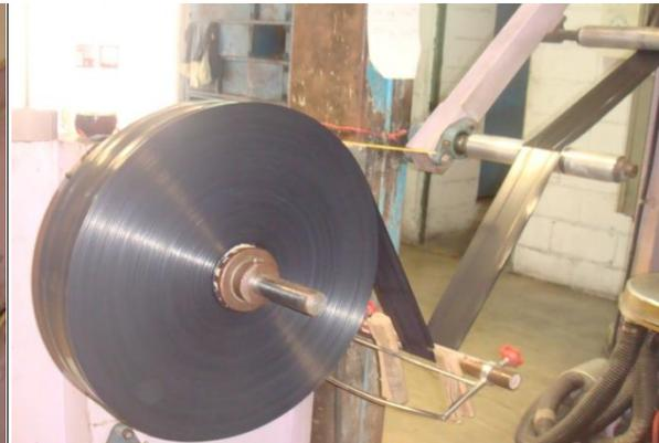
Fig. 2.11 Embobinador de película
