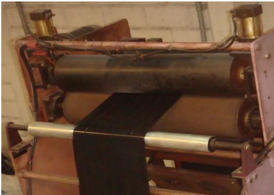
Fig. 2.10 Saliendo de los nip-rolls al Embobinador
