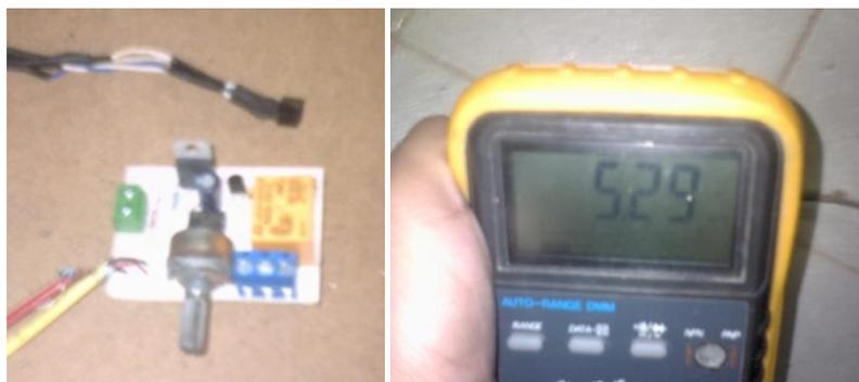
Fig. 3.30 Sensor CNY70 activando la señal para el PIC 16F877A
