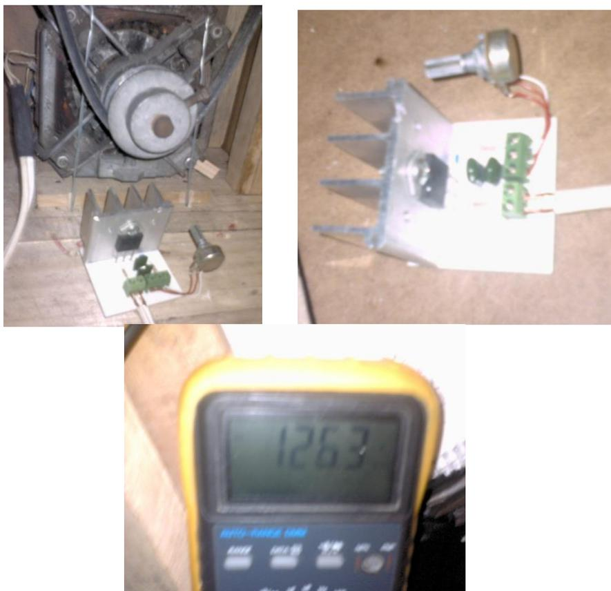
Fig. 3.26 Circuito regulador de corriente para el motor del husillo
