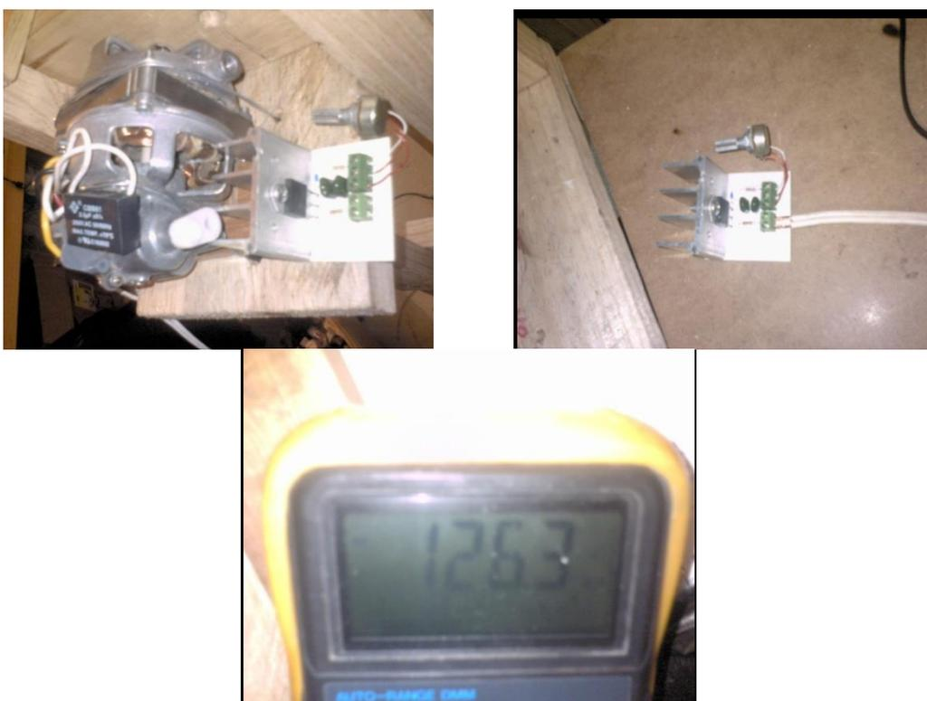
Fig. 3.27 Regulador de corriente del motor de los rodillos
