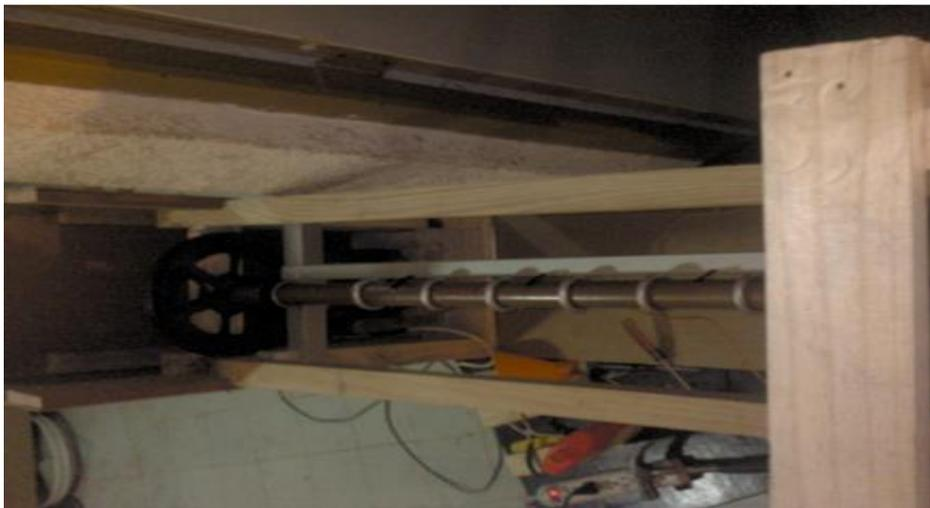
Fig. 3.22 Estructura de madera para el prototipo de extrusora. (Vista aérea)
