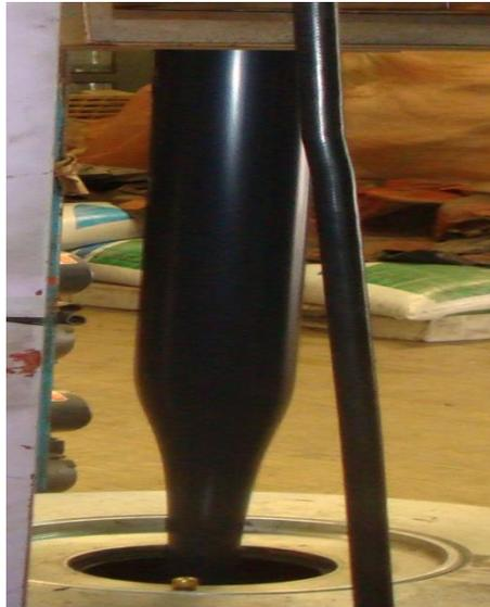
Fig. 2.9 Salida del dado, se solidifica y se dirige a los nip rolls.
