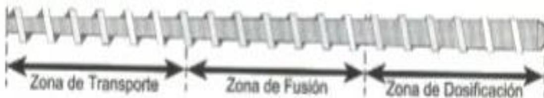
Fig. 2.4 Esquema de un tornillo simple de extrusión.
