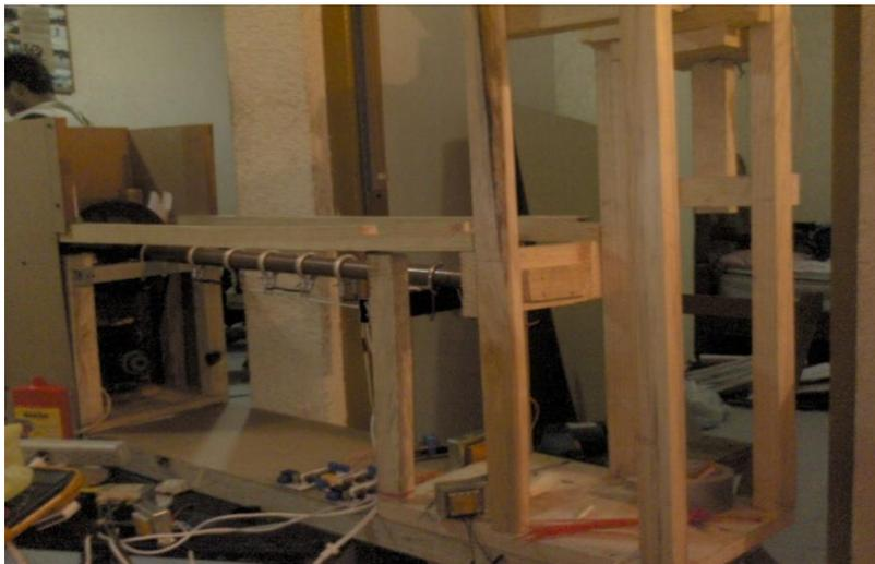
Fig. 3.21 Estructura de madera para el prototipo de extrusora. (Vista frontal)
