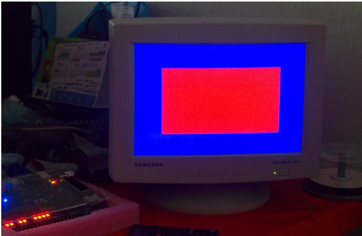
Figura 3.13 Monitor VGA con fondo azul y rectángulo rojo.
