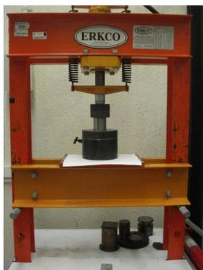
Figura 3.1 Foto de la prensa hidráulica y dado para la elaboración de pastillas a partir de materiales en polvo.
