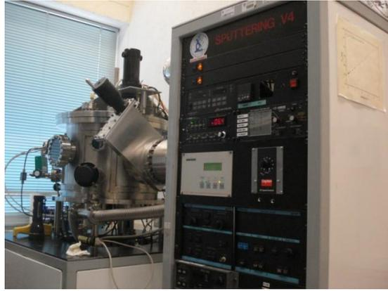
Figura 4.1. Sistema de Erosión catódica. Cámara de crecimiento y panel electrónico de control.
