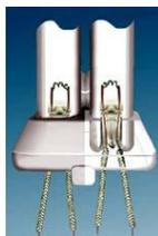
Fig. 6 Filamentos colocados dentro de los tubos de una lámpara CFL.
