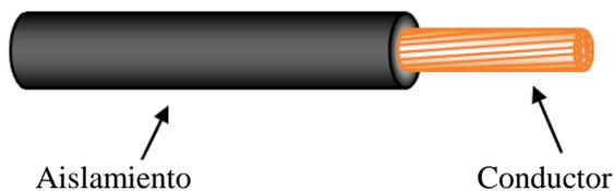
Fig. 31 Cable de baja tensión
