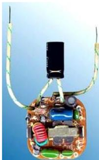
Fig. 7 Elementos que componen el balasto electrónico.
