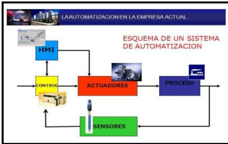
Figura 2.13 Esquema de un sistema de automatización.
