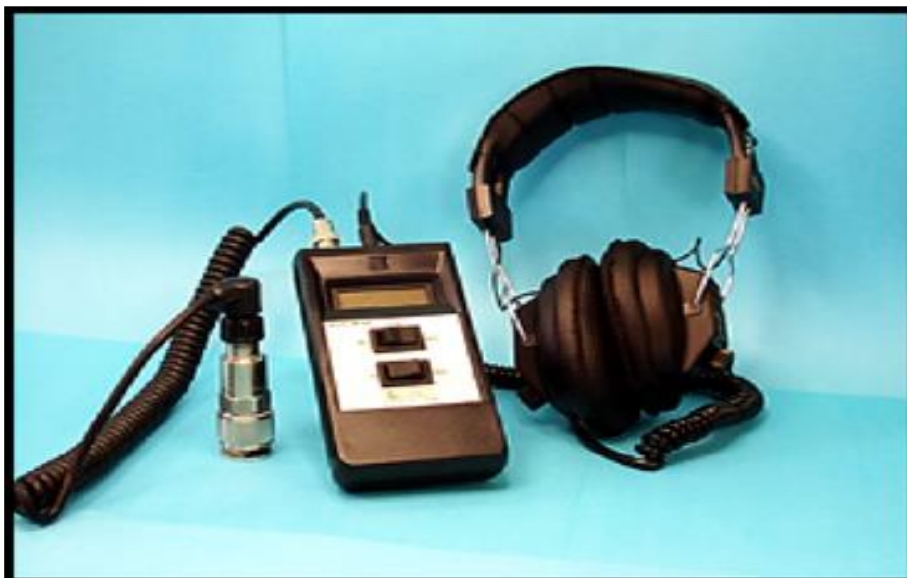
FIGURA 18 MEDIDOR DE VIBRACION A 1850
