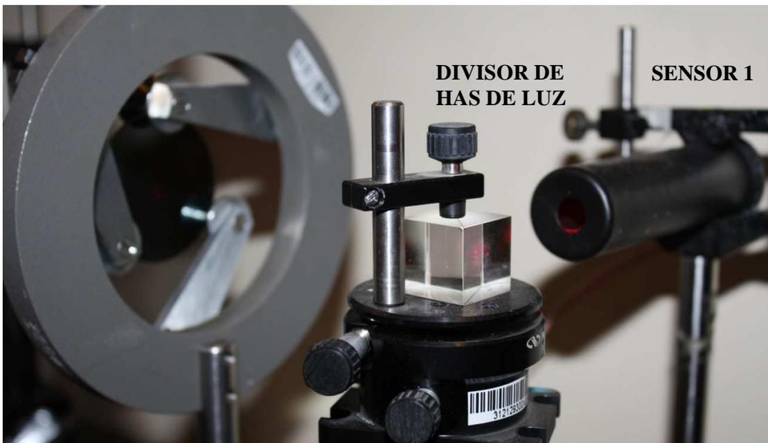
**FIG 3.8. componentes del sistema, sensor, divisor y polarizador1**
