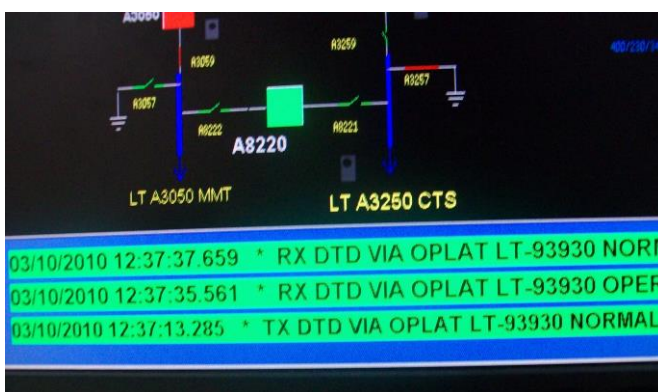
Figura 3.5.5 Señales correspondientes a la recepción y transmisión de un disparo del tipo DTD por vía OPLAT, como canal de transporte.
