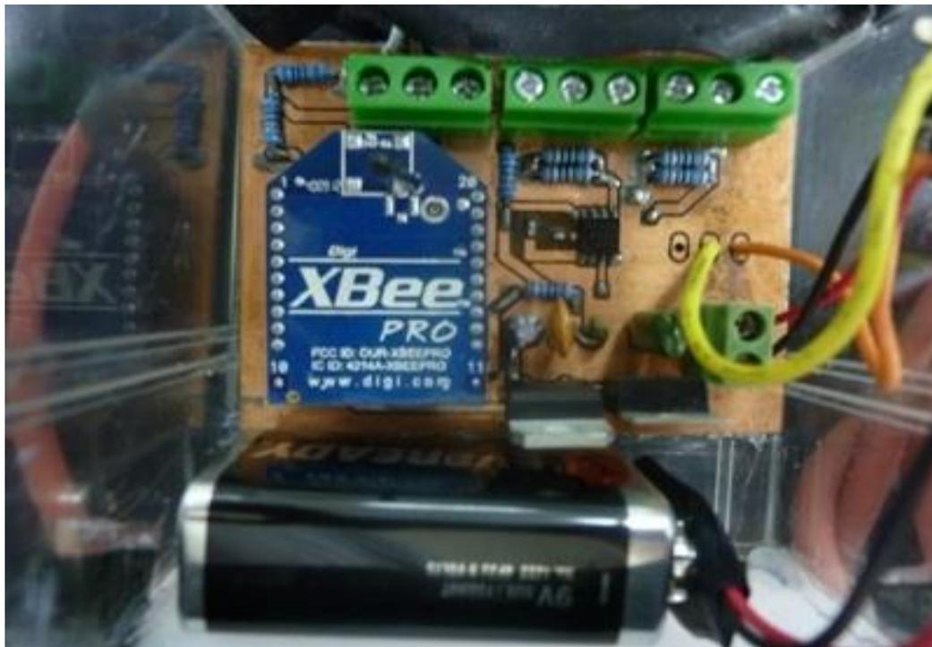
Fig.23. Tarjeta de desarrollo en conjunto con los módulos de transmisión
