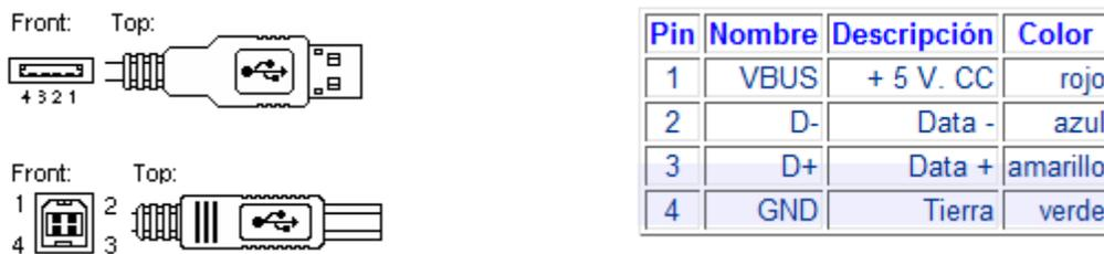
FIG.18. Conexión del cable de bus USB.
