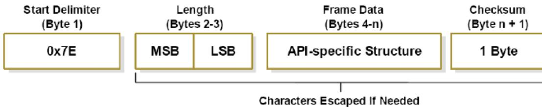
Fig. 17. Estructura del Frame del modo API.
