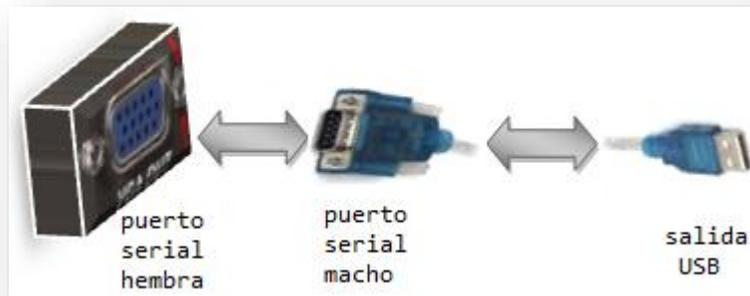
Figura 14 Adaptador serial a USB
