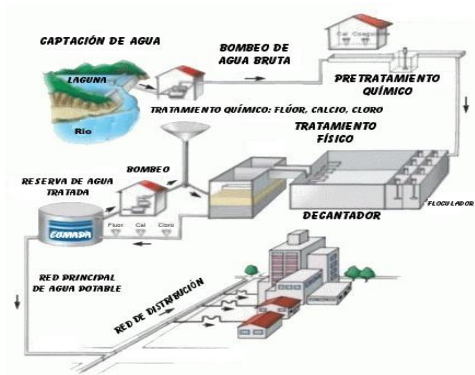
Figura 2. Etapas del proceso de tratamiento de agua.
