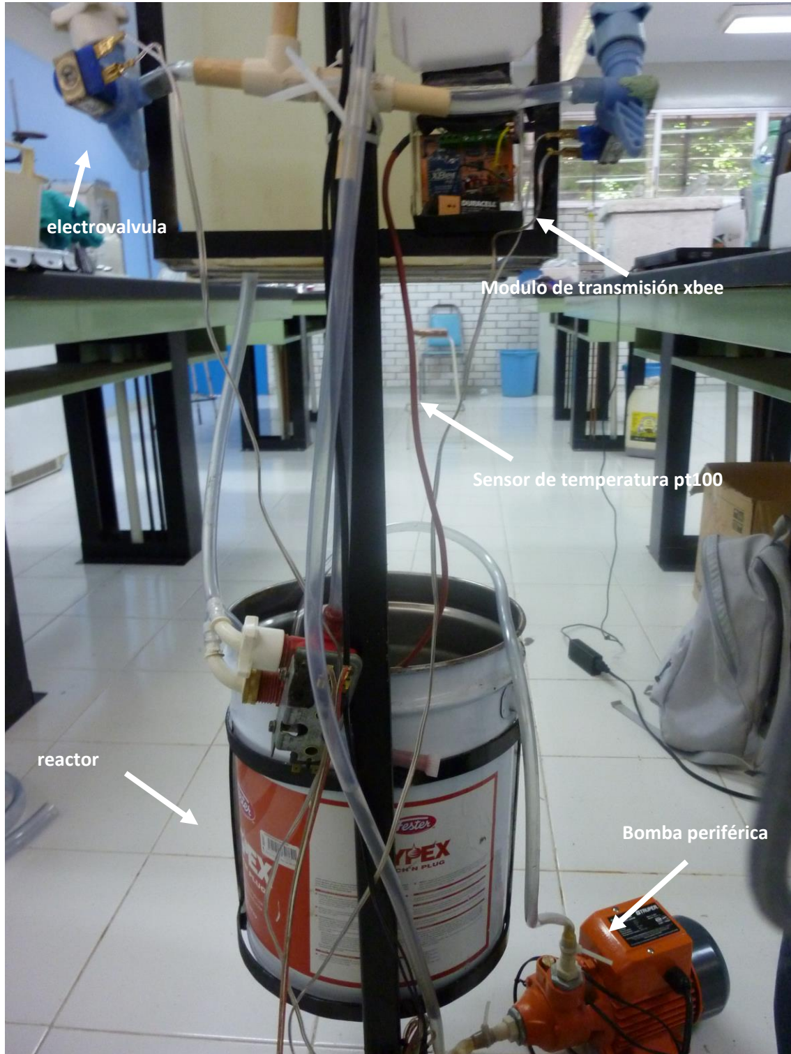
Figura 7.2.1 Modulo de transmisión xbee en el reactor
