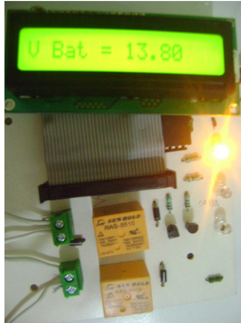
Fig. 28 led indicador de operación del circuito de carga
