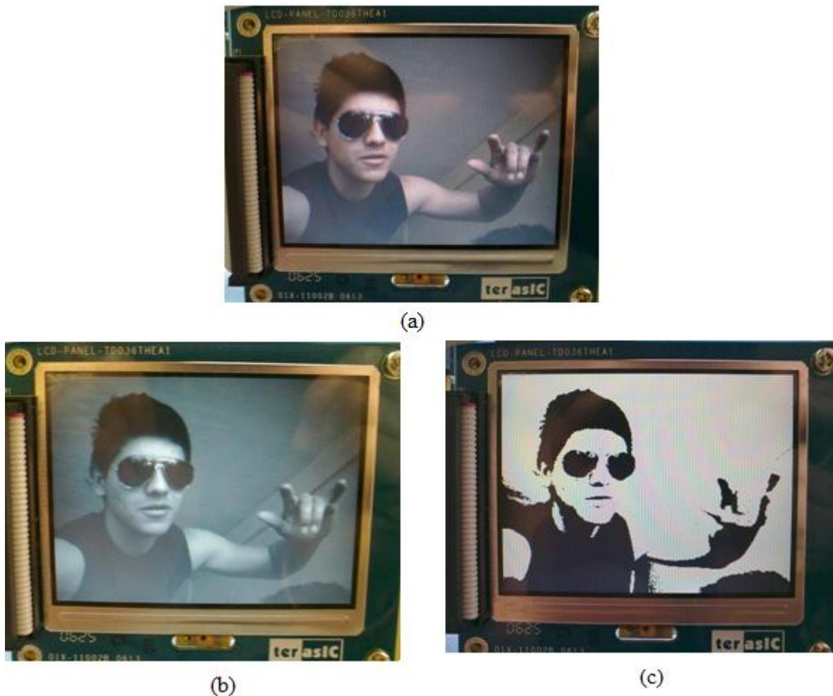
**Figura 4.4.** Binarización; (a) imagen original, (b) imagen a grises e (c) imagen binarizada
