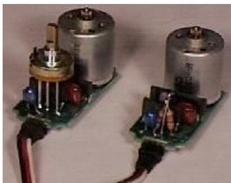
**Figura 3.46.** Circuito interno de los Servo motores
