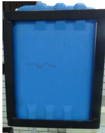
Figura 7.4: Recipiente contenedor de metóxido
