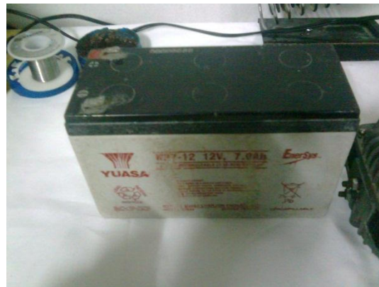
Figura 3.1.7 Batería a utilizar para la alimentación de los inversores
