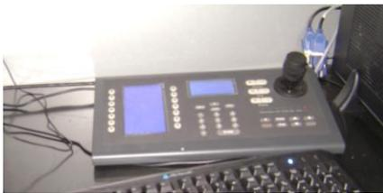
3 joysticks IP Marca SYSCOM modelo INK1000, los cuales se configuraron con las IP de cada cámara, Para su manejo se necesita colocar el número de cámara previa configuración y listo el joystick automáticamente nos ayuda a controlar las cámaras.
