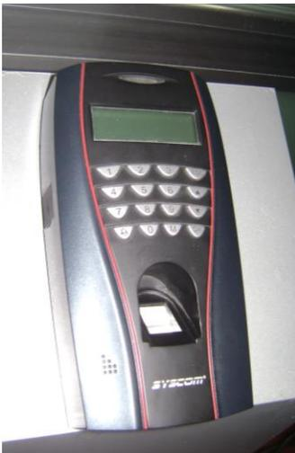
2 Lectores de Huella con Teclado y Lector de proximidad Integrado con Función de Tiempo y Asistencia. Marca SYSCOM modelo F9. Estos se instalaron siguiendo la línea de los 12 volts para alimentación y tienen una memoria de hasta 1,500 huellas.
