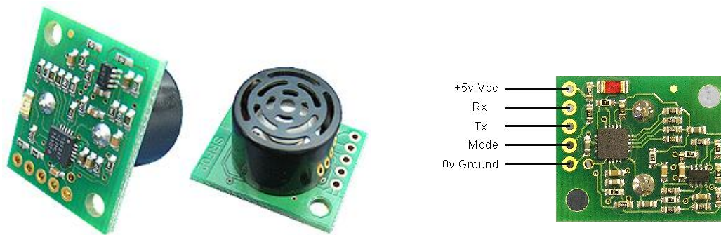
Sensores SRF02 y su distribucion de pines.
