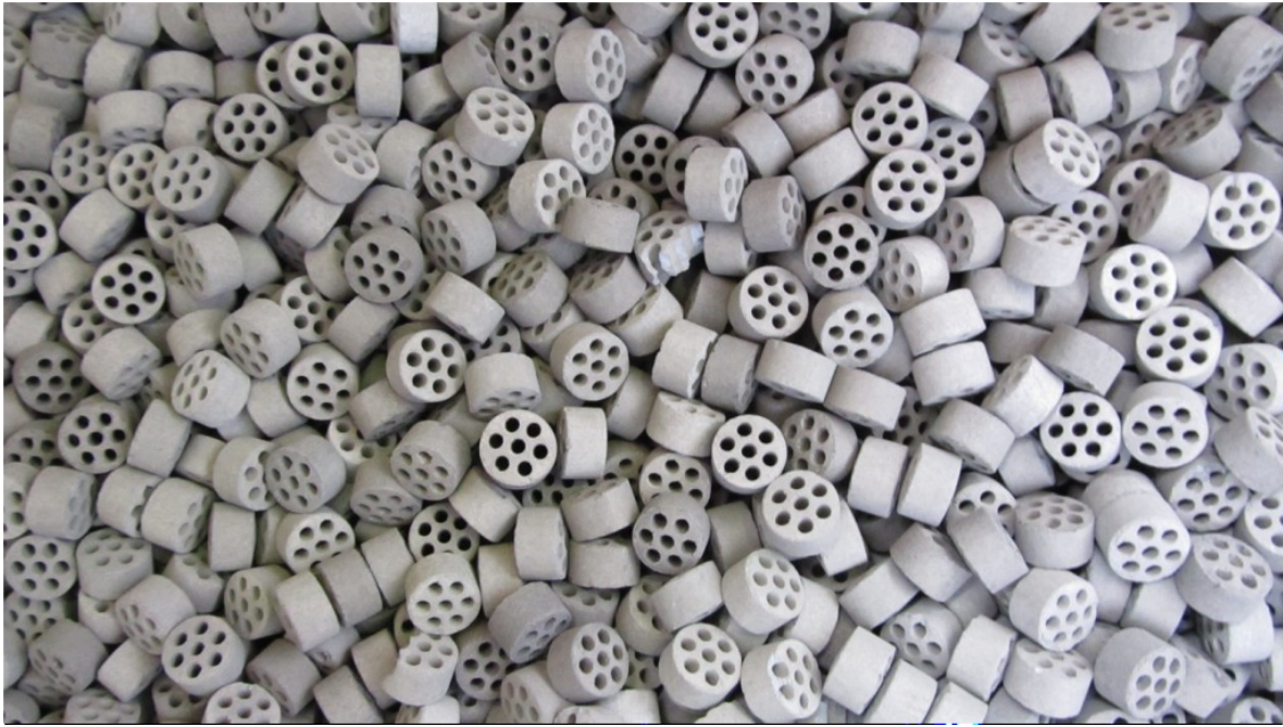
Catalizador de base Oxido de Níquel, antes de ser cargado dentro de un tubo catalítico que se remplazó.
