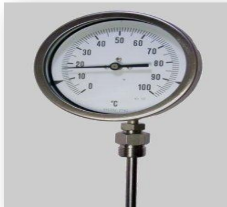
Fig. 4 Termómetros bimetalicos de capilar para la lectura de la temperatura en las cámaras de congelación.
