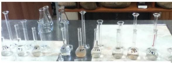
4. Recolectar el Cloruro de sodio decantado en matraces aforados de 50 ml, aforar a 50 ml con Cloruro de Sodio
