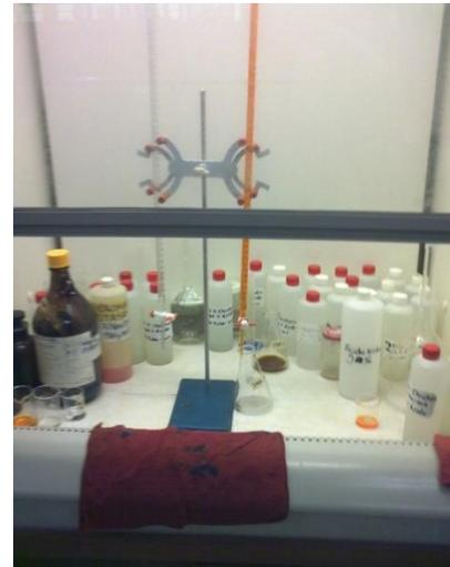
2. Llenar las buretas con Dicromato de potasio y con Acido sulfúrico
