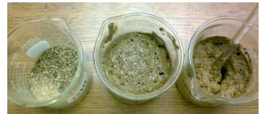
3. Agregar los 20 ml de peróxido, mezclar con el suelo, agregar otros 20 ml.
