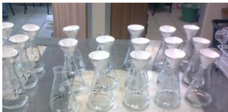
5. Vaciar la solución de cloruro de sodio en Matraces Erlenmeyer de 250 ml
