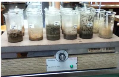
4. Calentar las muestras a 300° C para secar completamente
