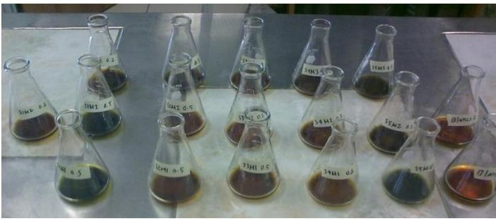
3. Agregar 5 ml de Dicromato de Potasio y 10 ml de Acido sulfúrico a cada muestra y dejar reposar por 30 min.
