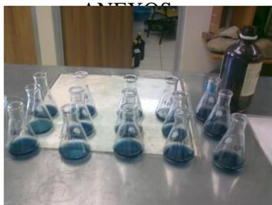
7. Agregar a la solución 5 gotas de clorhidrato de Hidroxilamina, 5 gotas de KCN al 2%, 5 gotas de Negro Ericromo T y titular con EDTA hasta el vire a azul.
