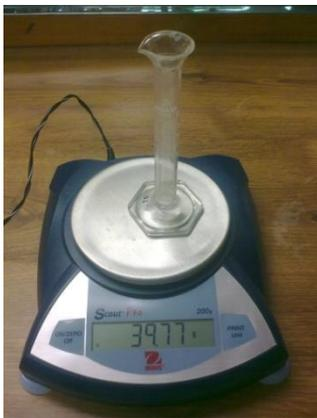
1. Pesar probeta de 10 ml vacía
