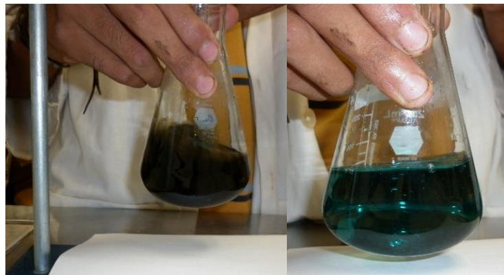
6. Agregar a las muestras 5 ml de Acido Fosfórico, 5 gotas del indicador Bariosulfato de Difenilamina y titular con Sulfato Ferroso, hasta el vire a azul turquesa
