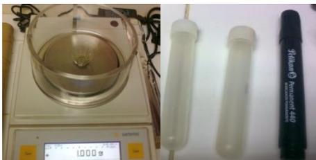
1. Pesar 1 gr de cada muestra y colocar en tubos para centrifuga
