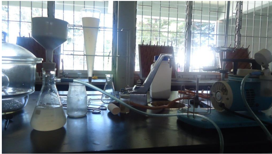
Fotografía IX.3.- preparación de embudo Schnauzer para determinación de grasas y aceites.
