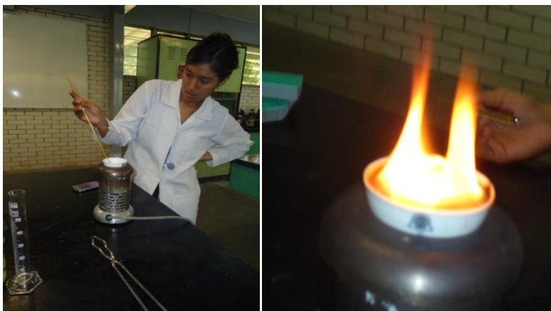
Ilustración 1 Pruebas de Inflamación del Biodiesel
