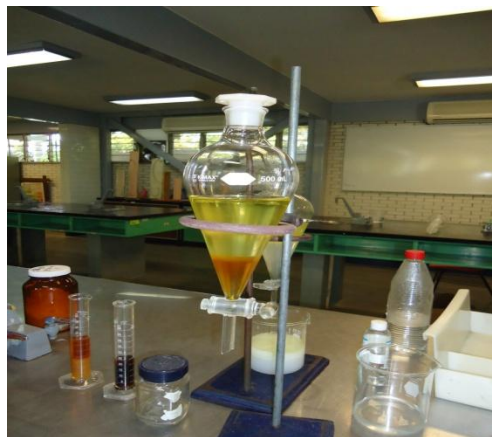
Figura 7.4 Separación del biodiesel y glicerina
