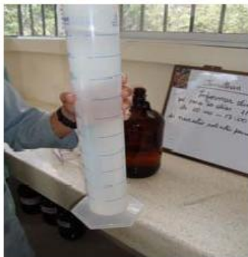
Figura 7.1 Medición volumétrica del metanol
