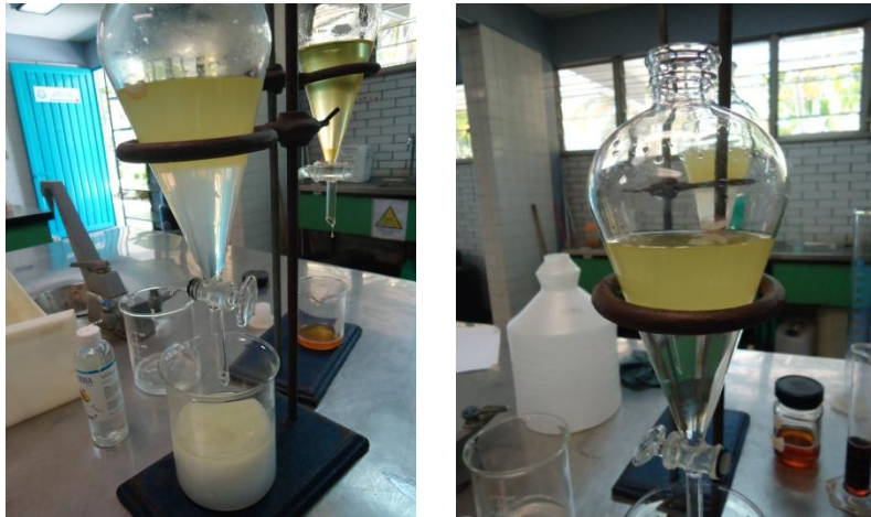
Figura 7.6 Lavado del Biodiesel para realizar la neutralización
