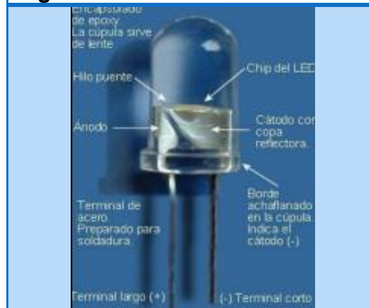
Figura 11.1 estructura de un LED
