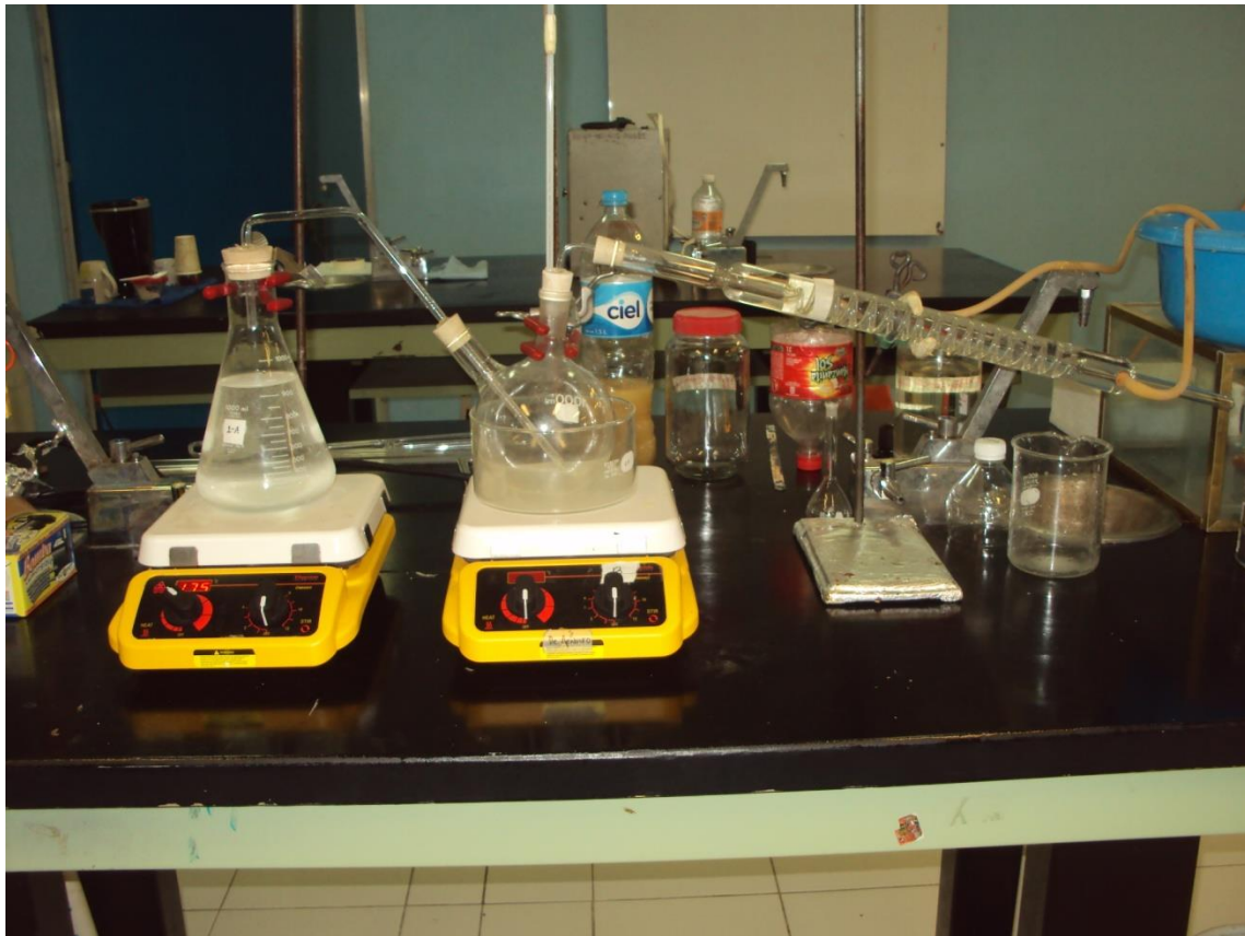
Figura 9.1. a) Sistema de destilación con producción de vapor en matraz.
