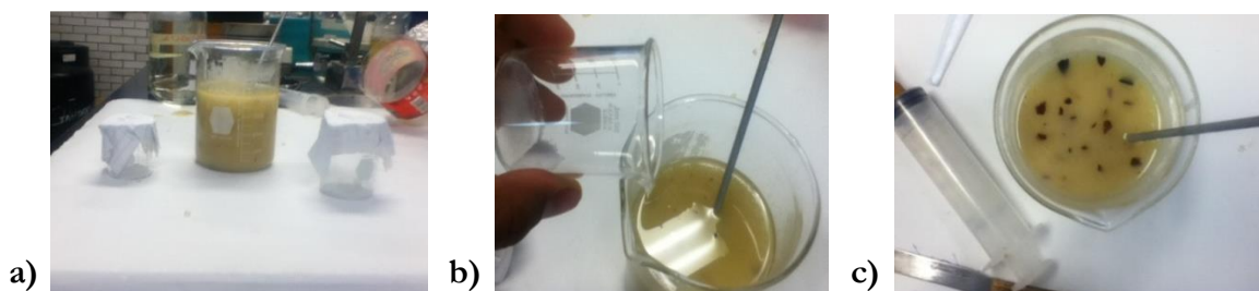
Figura 5.4. a) Muestra de resina, b) Agregando reactivos a la resina, c) Mezclado.
