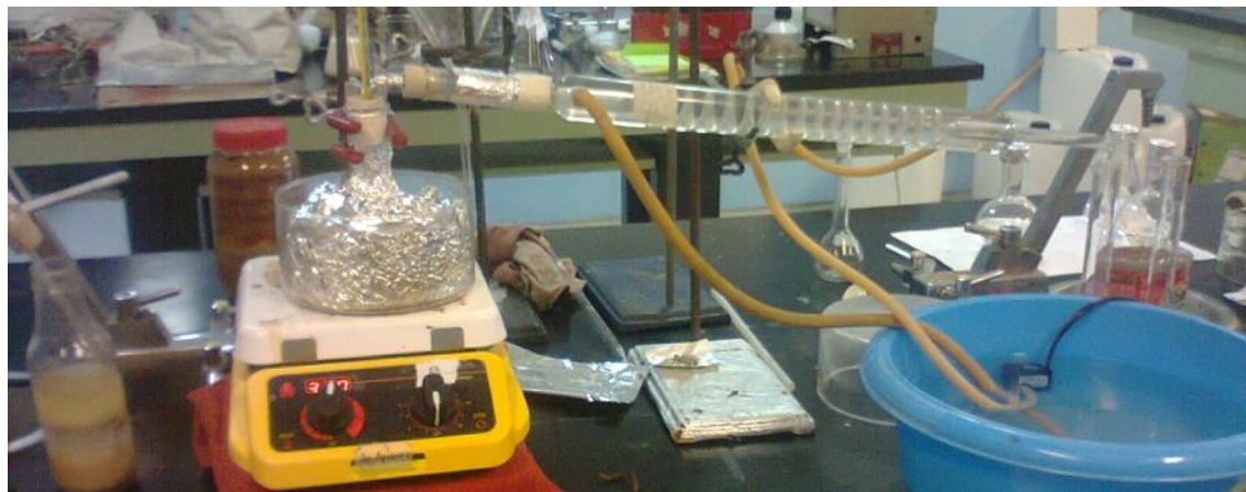
Figura 5.13. Sistema de destilación para realizar una curva de temperatura contra volumen.
