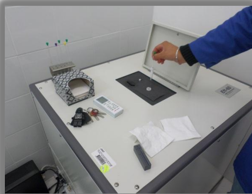
Figura 11.- Espectrofotómetro de RMN- 1 H marca Anasazi Instrument Inc, modelo Eft-60
