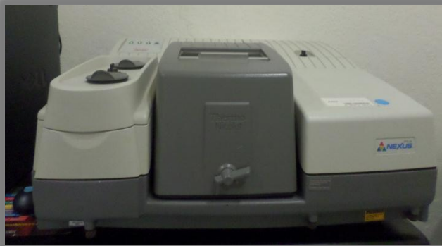
Figura 9.- Espectrofotómetro de Infrarrojo marca Thermo Nicolet, modelo Nexus 570
