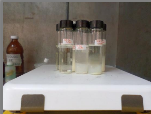
Figura 12.- Muestras de sales y el óxido de samario en mezclas del líquido iónico
