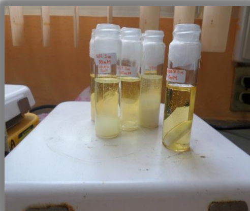
Figura 8.- Muestras del LI con las sales y el óxido de samario
