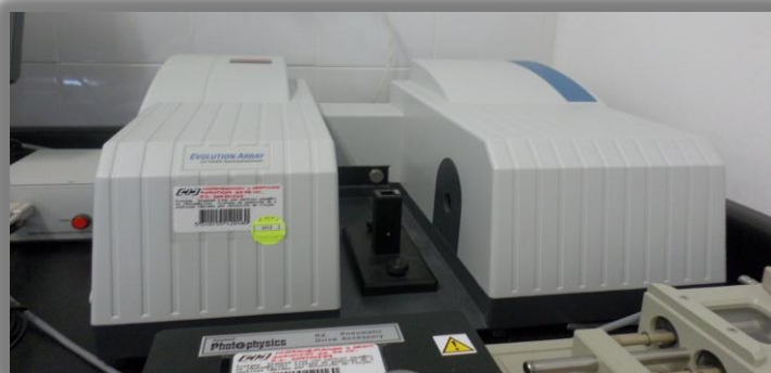
Figura 10.- Espectrofotómetro de Ultravioleta-visible marca Thermo Scientific, modelo EVOLUTION ARRAY
