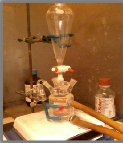
Figura 7.- Montaje de celda para síntesis de líquido iónico, acetato de 2 – hidroxiethylamonio
