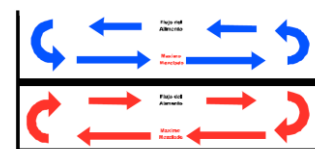
Fig. 2 Patrón de Mezclado en Mezcladoras horizontales de Listones.
