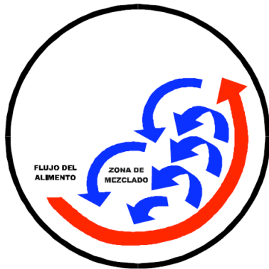
Figura 4. Ejemplo del movimiento que ejerce una mezcladora de tambor.
